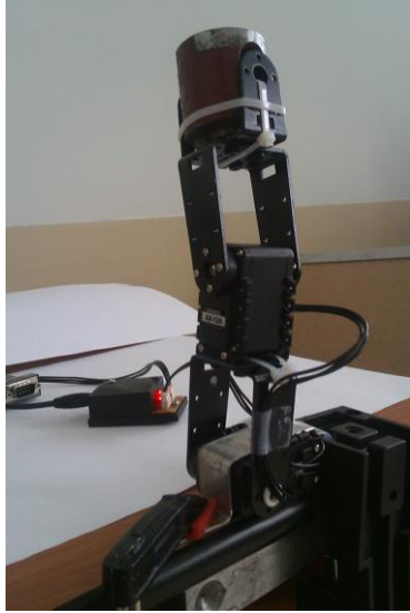
Ábra 1 – Két csuklóponos robotkar
